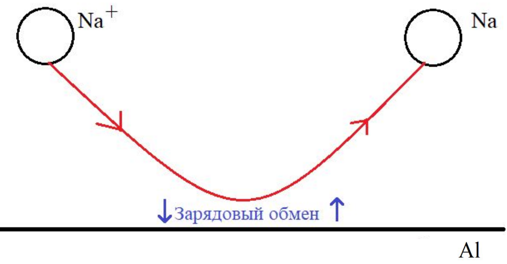
Рисунок 1: Иллюстрация зарядового обмена между ионом Na и металлической поверхностью Al.
