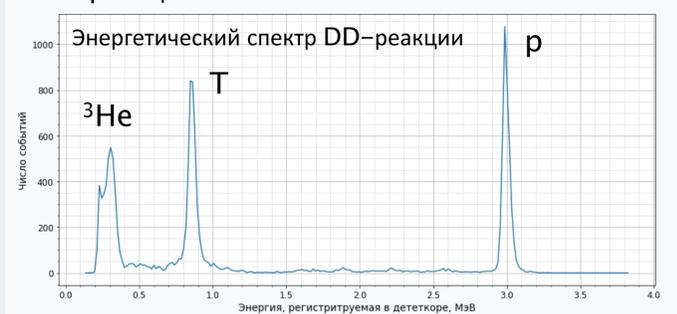
Спектрометр позволяет строить зависимости числа регистрируемых протонов в DD-реакции, по которым можно судить об интенсивности реакции в целом. Выход реакции растёт со временем и постепенно выходит на стационарный режим, в котором  $j_- \approx j_{\text{beam}}$ .
