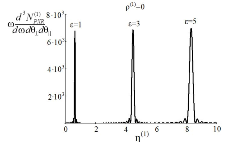
Рис.10. Асимметричные ( $\epsilon > 1, \epsilon < 1$ ) отражения излучения от слоистой структуры в геометрии рассеяния Брэгга. Случай  $\epsilon = 1$  ( $\delta = 0$ ) соответствует симметричному отражению.
