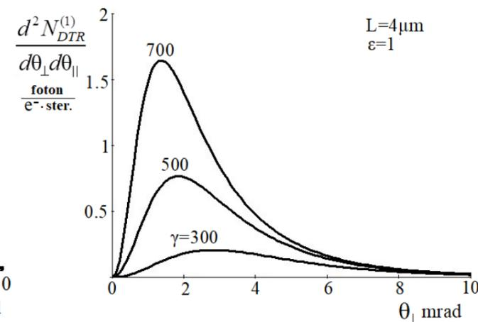
Рис.6. Угловые плотности ПРИ для различных энергий релятивистских электронов.
