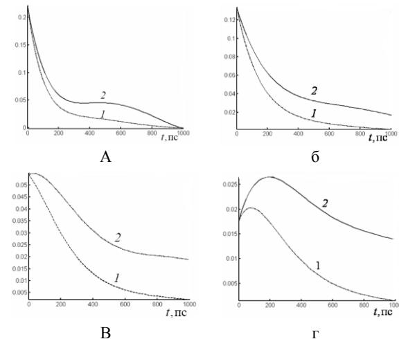
Рис. Сечения поверхностей  $c(r, t)$  (кривые 1) и поверхностей  $\tilde{c}(r, t)$  (кривые 2) для  $\tau_1 = \tau$  и  $\tau_2 = 10\tau$  при  $\tau = 382$  пс и коэффициенте  $\alpha = 0,1$ . Значения полярных радиусов  $r$ : а – 0 мкм, б – 0,5 мкм, в – 1 мкм, г – 1,5 мкм.
