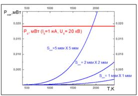
**Рис. 3.** Рассчитанные зависимости тепловой мощности, уносимой в вакуум излучением через площадки 5×5 мкм, 2×2 мкм и 1×1 мкм от абсолютной температуры Т этой площадки.
