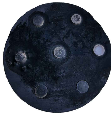
Графитовый катод с танталовыми вставками
