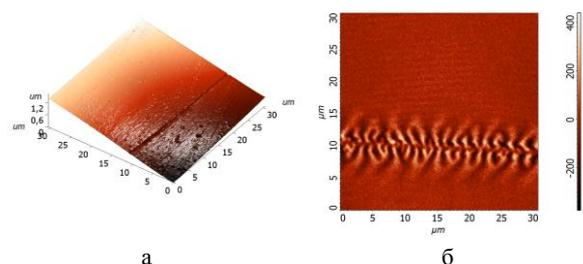
**Рис. 3.** а – АСМ изображение участка свободной стороны фольги с царапиной на поверхности; б – МСМ-изображение этого же участка фольги с замыкающими доменами. В верхней части рис. 3б видны полосовые домены.
