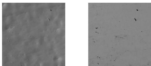
**Рис. 1.** РЭМ-изображение поверхности свободной стороны фольги: а – вторичная электронная эмиссия; б – обратные рассеянные электроны. Область сканирования 1x1 мм.
