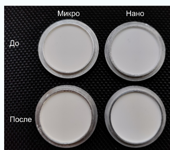
Рисунок 1 – Исследуемые микро- и нанопорошки Gd_2O_3 , запрессованные в подложки
