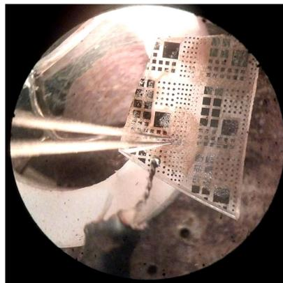
Были измерены КРС спектры комбинационного рассеяния, в конфокальном микроскопе снятые по нормали к рабочей поверхности КНС-структур при возбуждении зеленым лазером с длиной волны 514,5 нм.
