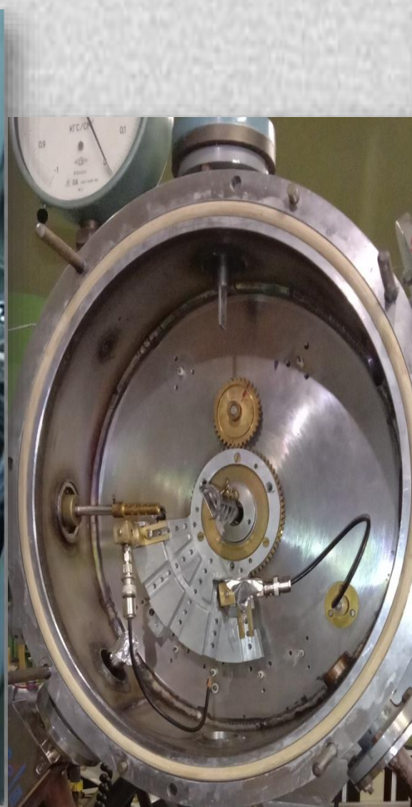
Рис.3. Камера ускорителя ЭГ-5 (Дубна, Россия) для RBS
