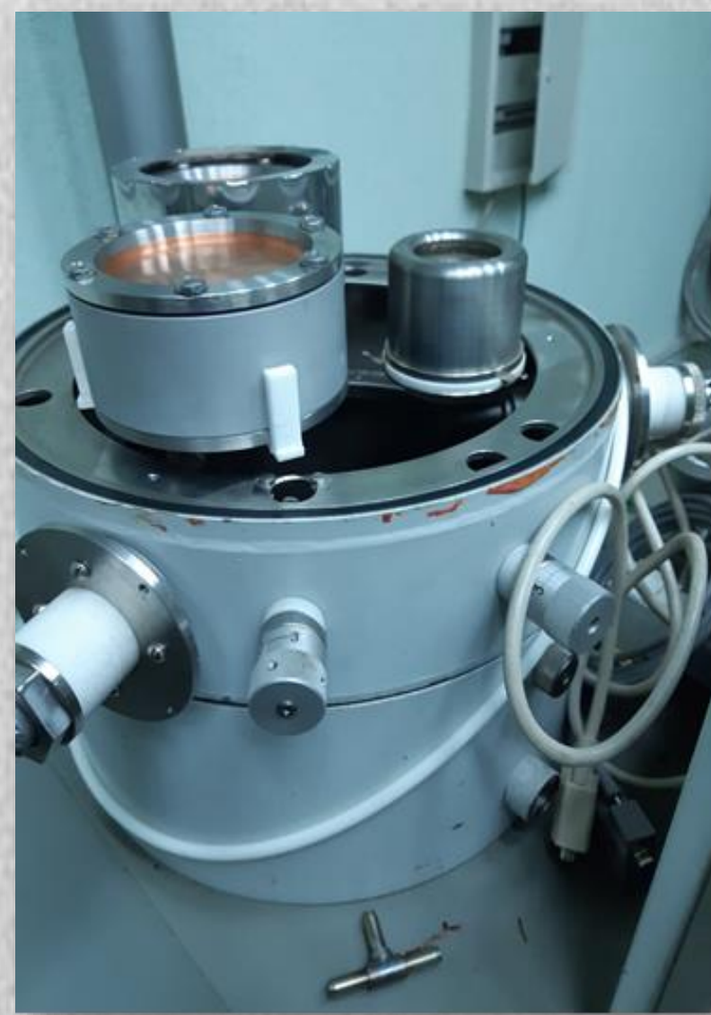
Рис. 2. ВУП-5М (Минск, Беларусь), где синтезируются пленки оксидов олова, легированные атомами ферромагнитных металлов (Ni, Co, Fe).
