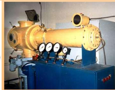
Рис.3 Фото импульсного ионного ускорителя ТЕМП, генерирующего мощный пучок ионов (C+/H+, 300 кэВ, 100 нс, 0.5-5 Дж/см<sup>2</sup>)
