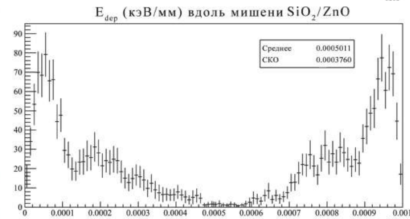
Моделирование в GEANT4, отношения количества поглощенной энергии относительно толщины мишеней
