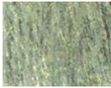
б б) поверхность образца, очищенная ионами плазмы тлеющего разряда
