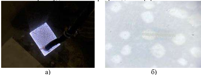
Рис 1. а) Процесс микродугового оксидирования на 12 минуте обработки; б) микрофотографии поверхности с покрытием при оптическом увеличении 60 крат.
