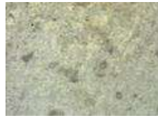
в в) образец, очищенный ионами плазмы тлеющего разряда (сталь 3) с нанесённым покрытием титана
