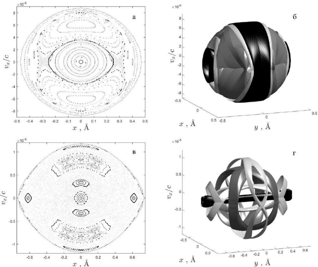
Сечения Пуанкаре (слева) и проекции четырехмерных областей регулярной динамики в фазовом пространстве на подпространство  $(x, y, v_x)$  (справа) для значений энергии поперечного движения 0.7687 эВ (вверху) и 1.3865 эВ (внизу).
