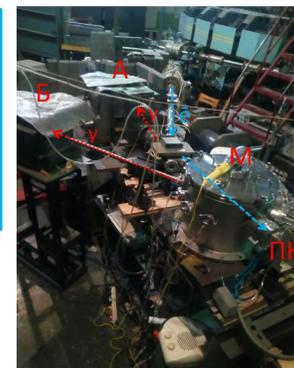
Фотография установки «Рентген 1»: А и Б фотонные каналы, М – мишенная камера, ПК – пропорциональная камера
