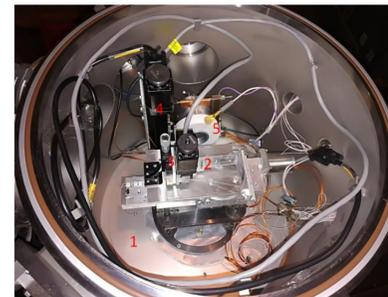
Фотография камеры для размещения мишени: мишенная камера (1), мишень (2) трехосевой гониометр (3), линейный транслятор (4) для перемещения цилиндра Фарадея (5).
